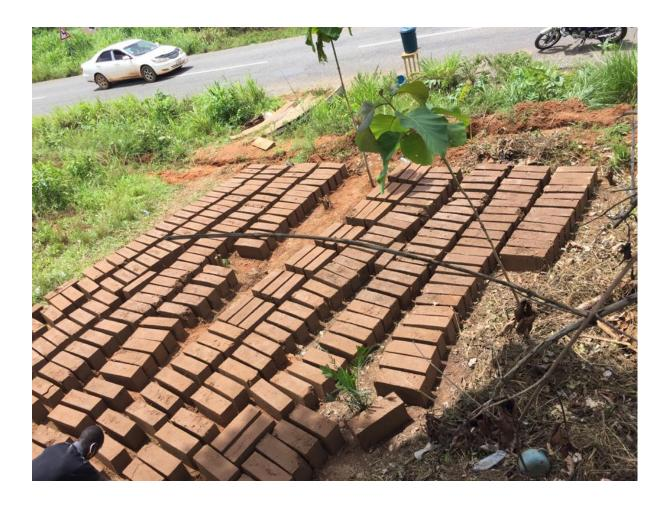
Die ersten selbst hergestellten Backsteine sind fertig und müssen nun in der Sonne für ein paar Tage trocken, ehe sie zum Bau der Toilettenhäuser verwendet werden können.
